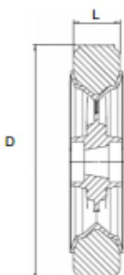
Des. 2 - Dimensões do Aro de ferro 8" com pneu.
