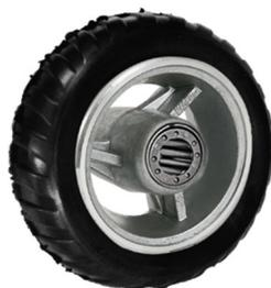
Fig.5- Foto do aro 4" com pneu semi maciço
